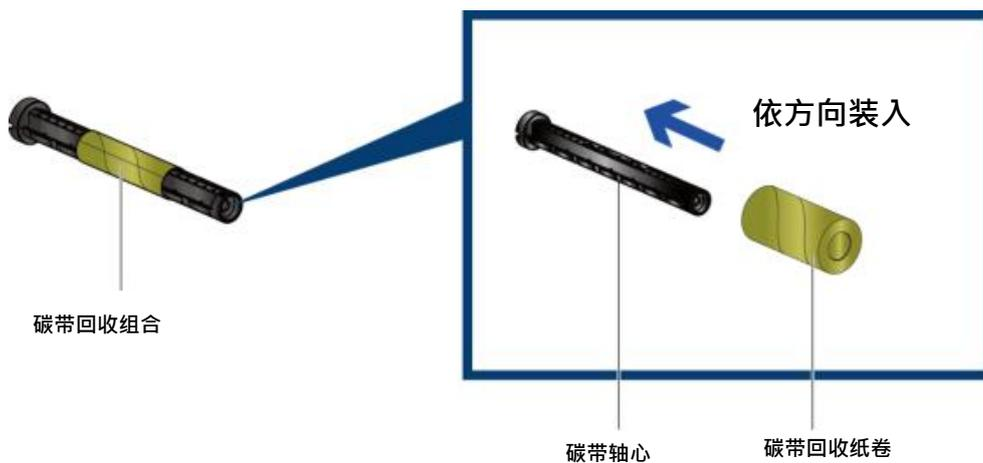
将碳带前缘粘在碳带回收纸卷上再卷绕 2~3 圈
