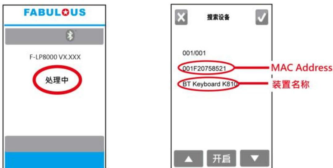
步骤 7. 待面板显示蓝牙键盘信息后，轻压下方“开启”键使打印机和蓝牙键盘建立联机，此时面板显示“请输入PIN码”
